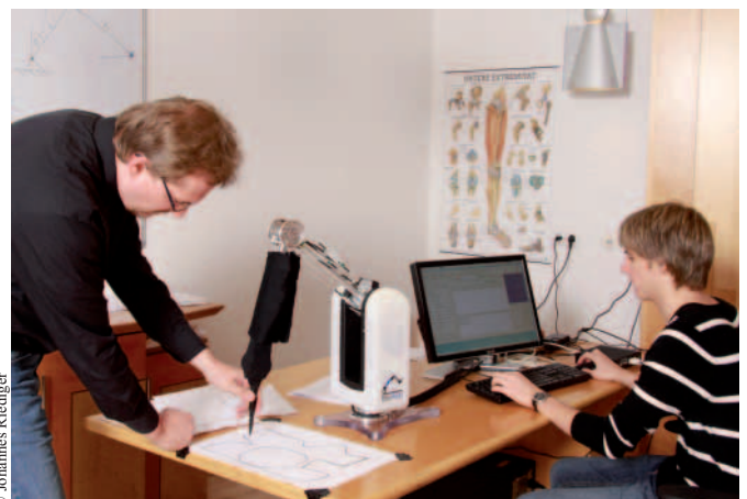
Man muss den Roboter angreifen und ihn einfach in die neue Position schieben, ohne dass man ihn erst programmiert.
